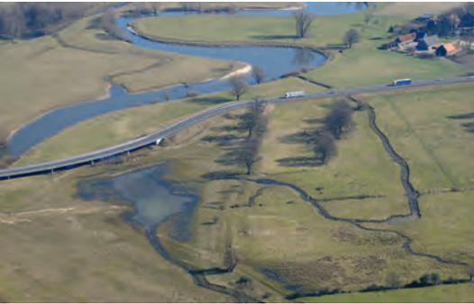
Abb. 61: Ein wiederhergestelltes Flutrinnensystem im Naturschutzgebiet „Disselmersch“ im Kreis Soest verbindet Fluss und Aue: Oben im Bild zweigt eine Rinne von der Lippe ab, nimmt einen kleinen, auf dem Foto von rechts kommenden Bach auf und füllt eine flache Senke an der Brücke. Von hier setzt sich die Flutrinne nach vorn in Bildmitte fort.
