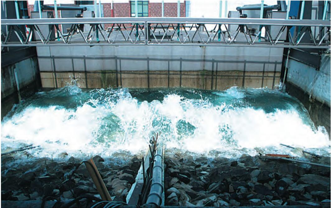
Abb. 12: Die Wellensimulationsanlage in der Bundesforschungsanstalt für Wasserbau in Karlsruhe.
