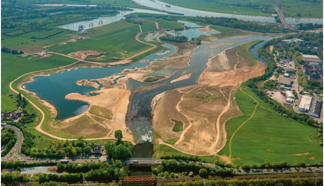
Abb.19: Die erweiterte, tiefergelegte und neu gestaltete Aue im Bereich der Lippemündung in den Rhein (im Hintergrund) bei Wesel. Gut zu erkennen sind die vielfältigen und flach auslaufenden Ufer in den Auenbereichen sowie die vielgestaltige Reliefgestaltung durch die Lippe im Strom (Foto: Emschergenossenschaft/ Lippeverband).
