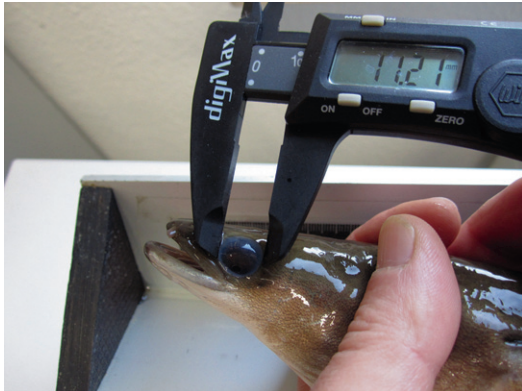
Abb. 19: Messung des Augendurchmessers mittels Schiebelehre
