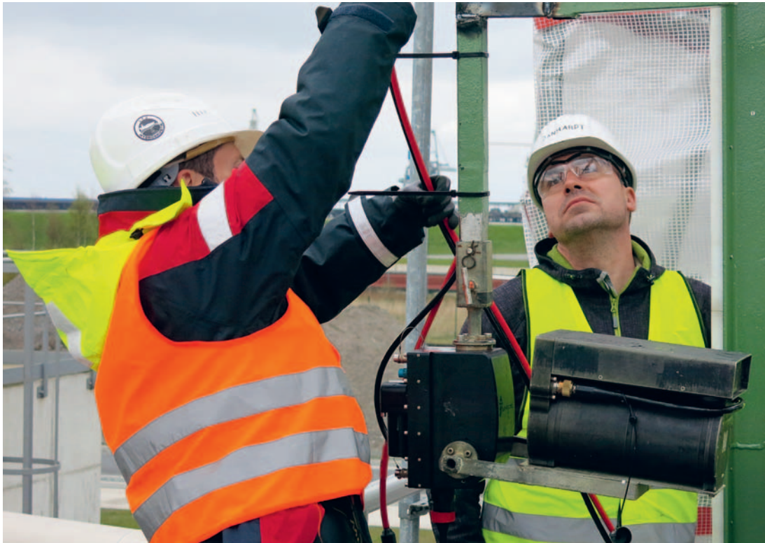
Der Kollege Manuel Langkau (links) montiert gemeinsam mit dem Meeresbiologen Dr. Andreas Dähnhardt ein DIDSON-Sonar für die Datenerfassung an einer Kühlwasserentnahmestelle im niedersächsischen Wattenmeer.
