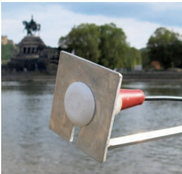
Schallgeber eines EK15-Echolotes zur Erfassung der sohnnahen Fischfauna, hier am Deutschen Eck in Koblenz.
