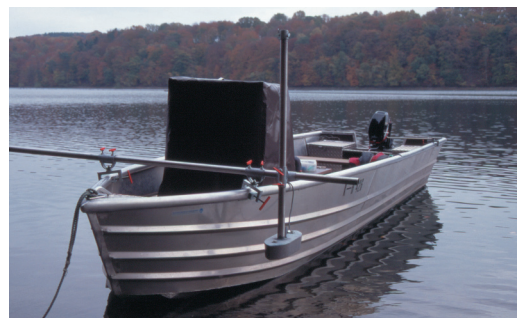
Abb. 12: Boot mit montiertem Echolot (Schallgeber im Vordergrund über der Wasseroberfläche).
